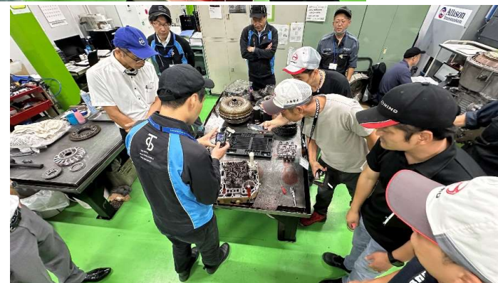
ATの分解は販売会社でやらないので、とても興味深い。次々に分解されていく部品を一つずつ状態をチェックするメカ達。☞
