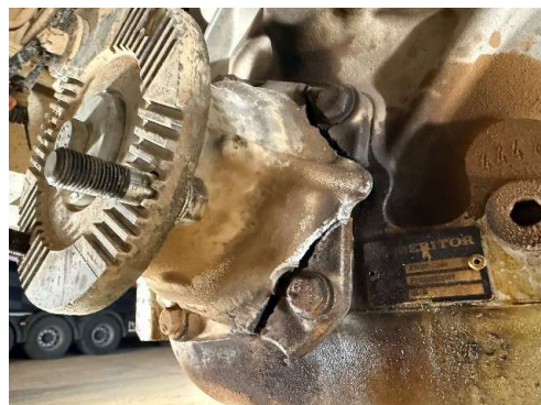
↑大きな入力によるトランスファーの破損箇所
