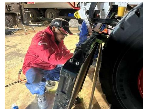
←ラジエーターからの冷却水漏れも同時に発生しており、ラジエーター交換をする柏谷メカ
